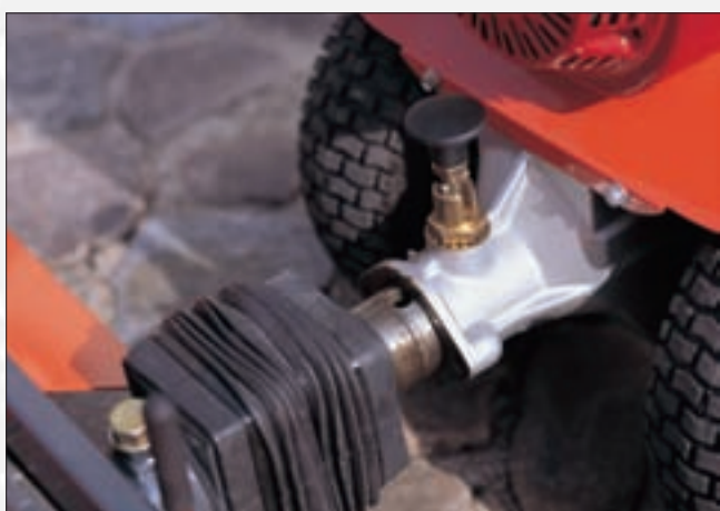
Geräte-Schnellkuppelsystem mit Zentralrohranschluß für schnellen und werkzeuglosen Wechsel der Anbaugeräte. Geräteantrieb über vollgekapselte und robuste Gelenkwelle.
