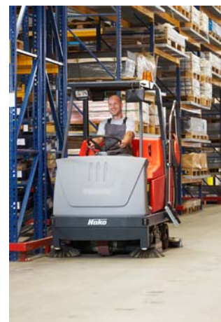
Hakomatic B 1050: Kehren, Schrubben und Absaugen in einem Arbeitsgang – bequem im Sitzen.
