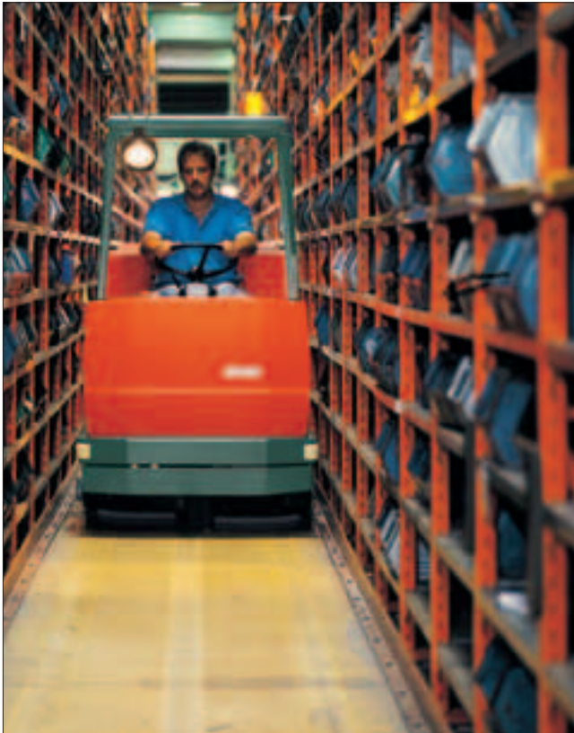
Ohne Kehrsaugvorsatz selbst in engen Gängen problemlos Naßschrubben und Trockensaugen.
