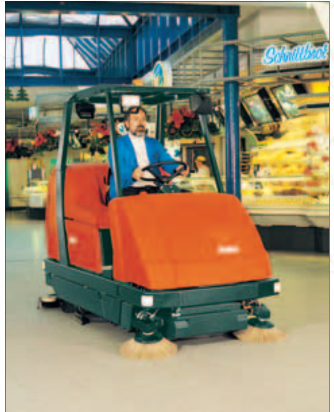
Mit Kehrsaugvorsatz in nur einem Arbeitsgang Kehrsaugen, Naßschrubben und Trockensaugen.
