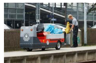
Der neue Hako-Sherpa S 8 kann bis zu 800 kg zuladen und zusätzlich noch bis zu 2 t ziehen.
