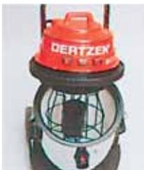
Alle Naß-Trockensauger haben ein Schwimmerventil zur Abschaltung des Saugstroms – damit die Turbinen nicht durch Wasserschlag zerstört werden.
