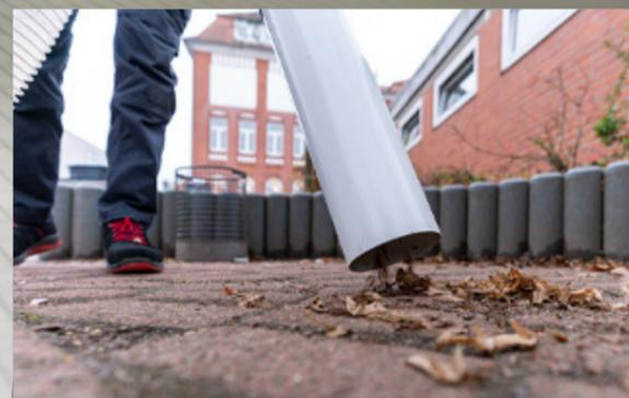
Noch flexibler im Einsatz: Mit dem optionalen Handsaugschlauch können auch für die Maschine unzugängliche Bereiche erreicht werden.
