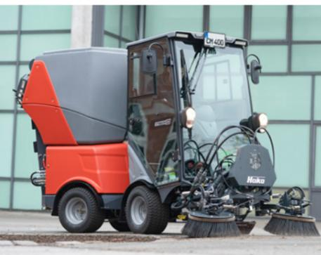
Zuverlässig für saubere Flächen: mit hydraulisch angetriebener 2-Besen-Kehreinheit und patentiertem Umlaufwassersystem für reduzierte Partikel- und Feinstaubemissionen.
