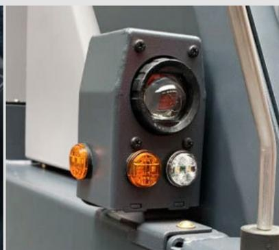
**Beleuchtung nach StVO:** Für bessere Erkennbarkeit zum Beispiel bei Arbeiten in Außenbereichen können die Scrubmaster mit StVO-zugelassenen lichttechnischen Einrichtungen ausgestattet werden.
