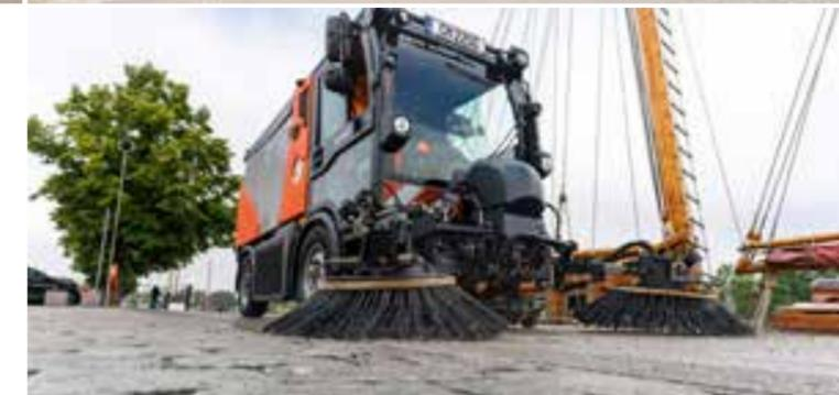
Für zuverlässige und sichere Ergebnisse: Der rollengeführte Saugmund mit Gummidichtleisten steigert die Schmutzaufnahmefähigkeit – und verringert gleichzeitig Anfahrschäden und Verschleiß. Die optionale Saugmundkamera informiert zusätzlich über mögliche Materialanhäufungen.
