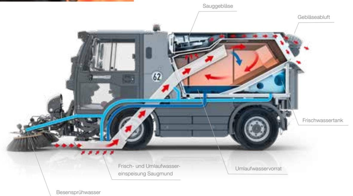
Kehrgut wird von den Besen über einen Saugmund direkt und sicher in den Behälter gesaugt. Der Saugmund fährt auf Rollen vorwärts und auch rückwärts. Das Frisch- und Umlaufwassersystem bindet den Staub effektiv.
