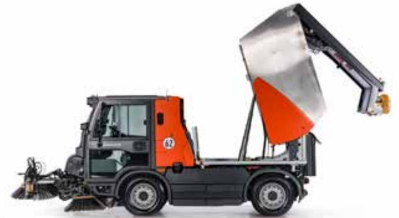
Der glattflächige Edelstahlbehälter lässt sich schnell und gut entleeren und ist besonders leicht zu reinigen.
