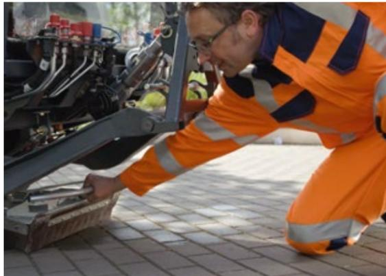
**Schnell einsatzbereit:** dank Schnellkuppeldreieck für den einfachen, werkzeuglosen und rücken-schonenden Gerätewechsel.
