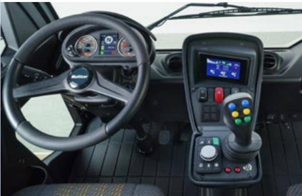
Alles im Blick, alles im Griff: Joystick für intuitives Ansteuern der Grundfunktionen, übersichtlich angeordnetes Bedienfeld mit leicht zu erreichenden Tasten und farbiges Display für die Anzeige wichtiger Informationen.
