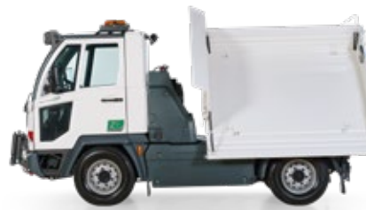
Flexibel: 3-Seiten-Kippaufbau, z.B. für den Transport von Schüttgütern oder im Baustelleneinsatz.
