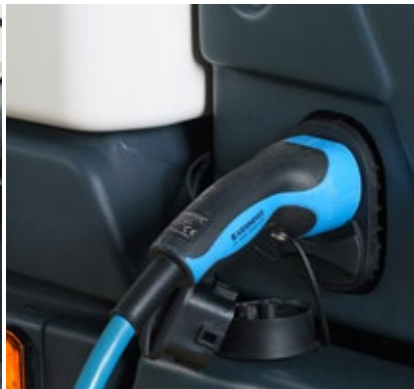
Schnelles, einfaches und sicheres Aufladen: über Nacht mit 22 kW AC oder auch mal zwischendurch mit bis zu 120 kW DC (Schnellladen).
