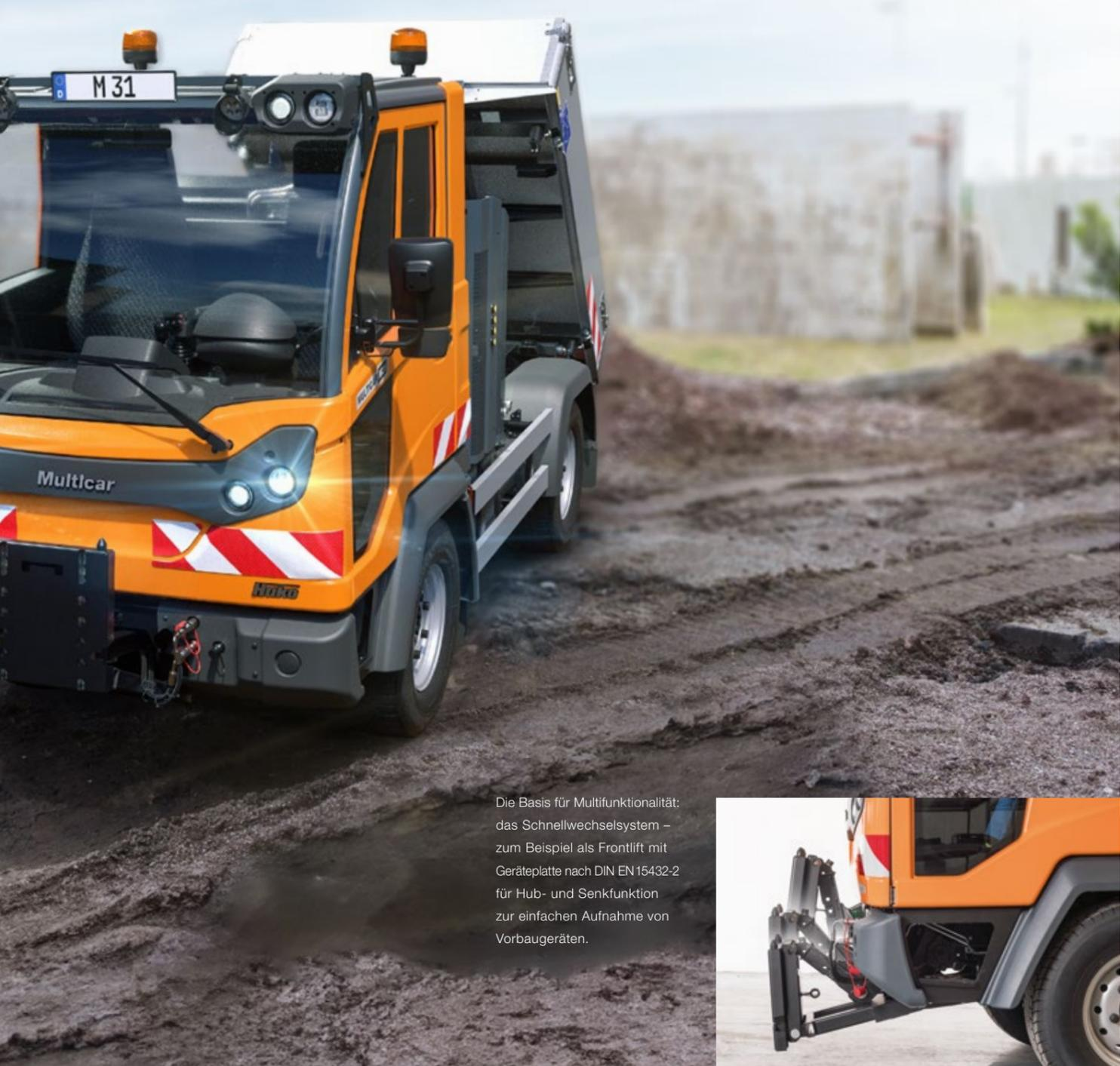
Die Basis für Multifunktionalität: das Schnellwechselsystem – zum Beispiel als Frontlift mit Geräteplatte nach DIN EN 15432-2 für Hub- und Senkfunktion zur einfachen Aufnahme von Vorbaugeräten.
