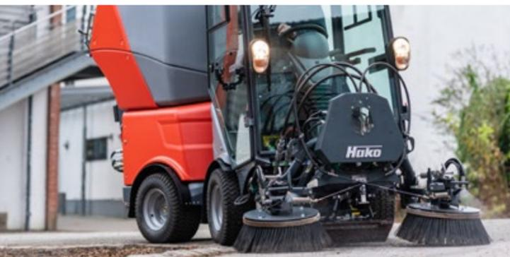
Sauber im Kehreinsatz: dank hydraulisch angetriebener 2-Besen-Kehreinheit und patentiertem Umlaufwassersystem.
