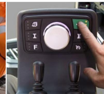
Mit der komfortabel in die Bedienarmlehne integrierten 1-Knopf-Bedienung starten die Fahrenden den automatisierten Funktionsablauf selbst komplexer Maschinenkonfigurationen auf Knopfdruck. Das Mobiltelefon der Bedienenden kann über das Radio als Freisprecheinrichtung genutzt und über die USB-Schnittstelle geladen werden. Für sichere Erreichbarkeit.
