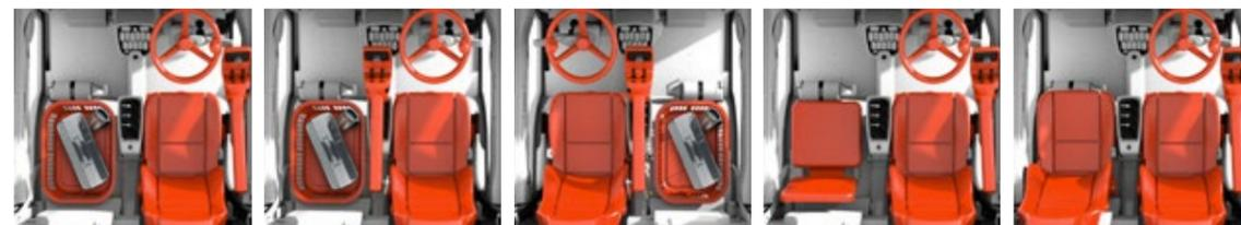
Wie für die Fahrenden gemacht: Verschiedene Sitzkonfigurationen mit Komfort- oder Notsitz sowie mit oder ohne Ablagemöglichkeiten erlauben nicht nur eine variable Raumnutzung, sondern geben den Bedienenden auch ein deutliches Extra an Platz in der Fahrerkabine.
