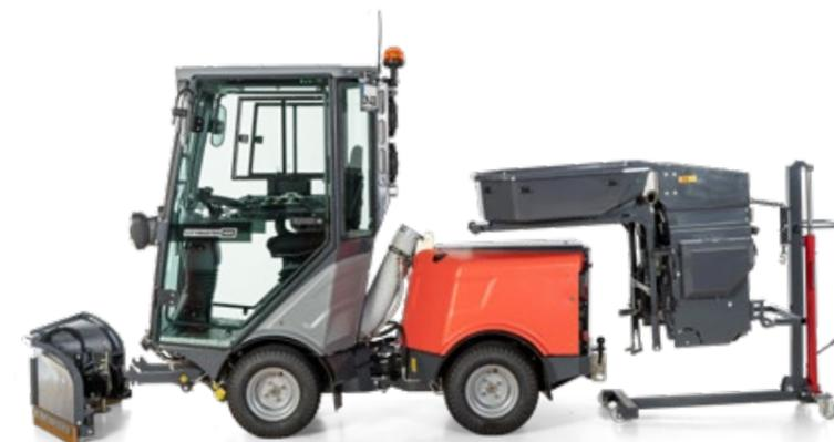
Das Schnellwechselsystem ermöglicht einen einfachen, werkzeuglosen und rückschonenden Gerätewechsel. Auch Heckaufbauten können dank einzigartiger Schnellkupplungen von nur einer Person gewechselt werden.
