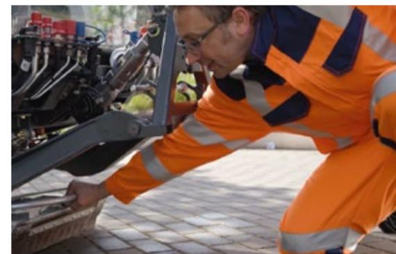
Gerätewechsel leicht gemacht: mit Schnellwechselsystem und Schnellkuppeldreieck für den werkzeuglosen, rückschonenden Austausch von Anbaugeräten.
