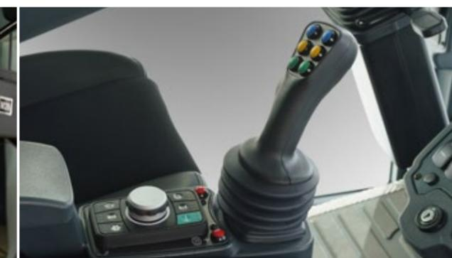
Gerätefunktionen und der hydrostatische Fahrtrieb können einfach und zentral per Joystick gesteuert werden.
