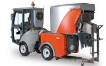
Einfach im Wechsel – Behälter- und Zubehörwechsel komfortabel und rückschonend mit Schnellkupplungssystem und Rollwagen.
