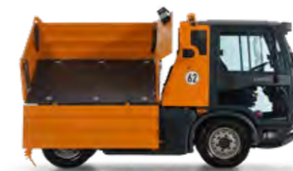
Seitenkipper für schnelles, kontrolliertes Entladen – auch bei beengten Platzverhältnissen.
