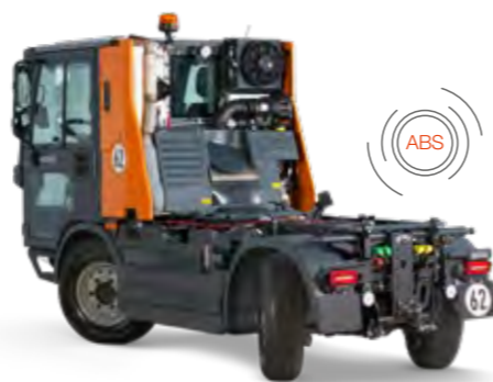
Vorbildliche Wendigkeit eines Lkw-Geräteträgers – mit Vierradlenkung um jede Ecke.
