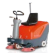
Sweepmaster B800 R Flächenleistung bis zu 6.600 m 2 /h, 89 oder 110 cm Arbeitsbreite
