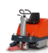
Sweepmaster 900 R Flächenleistung bis zu 7.200 m 2 /h, 95 oder 120 cm Arbeitsbreite
