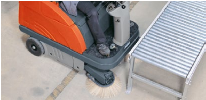
Extreme Wendigkeit Der Lenkwinkel von 90 Grad ermöglicht kleine Wendekreise auch unter besonders beengten Verhältnissen.
