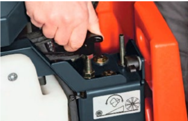
Verschleißausgleich Die Einstellung der Hauptkehrwalze mit dem ABBA-System (Automatische Behälter-Besen-Anpassung) sichert ausgezeichnete Kehrergebnisse über die gesamte Lebensdauer der Walze.
