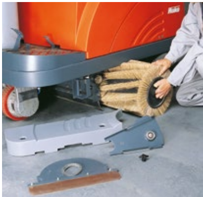
Einfacher Walzenwechsel Die Kehrwalze lässt sich besonders einfach austauschen – ohne Werkzeugeinsatz.
