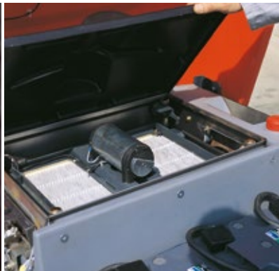
Effektiver Staubfilter Für saubere Abluft und lange Einsatzzeiten sorgt das leicht zugängliche Kassetten-Filterssystem mit großer Filterfläche und patentierter R 2 S-Filterreinigungstechnologie.
