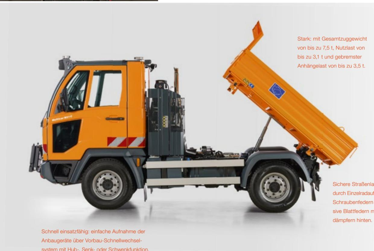
Stark: mit Gesamtzuggewicht von bis zu 7,5 t, Nutzlast von bis zu 3,1 t und gebremster Anhängelast von bis zu 3,5 t.
