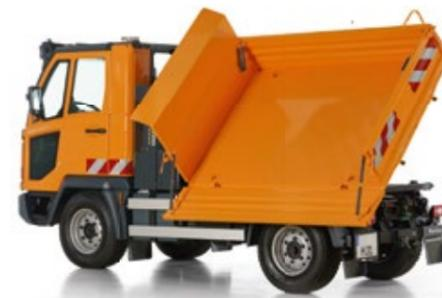
Flexibel: als Dreiseitenkipper mit variabel hydraulisch nutzbaren Kipprichtungen.
