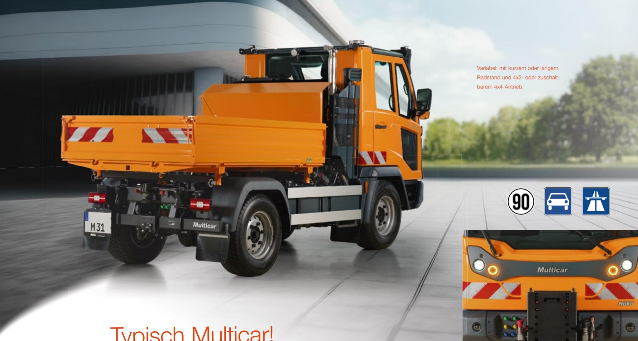
Variabel: mit kurzem oder langem Radstand und 4x2- oder zuschaltbarem 4x4-Antrieb.
