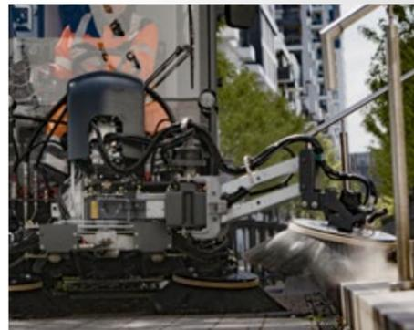
Erreicht mühelos die nächste Stufe: Mit zusätzlichem Besen können verschiedene Ebenen gleichzeitig gereinigt werden.
