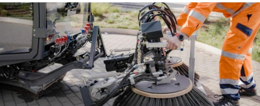
Schnell gewechselt: Nur eine Person kann allein An- und Aufbauten wechseln – ohne Einsatz von Werkstatt oder Werkzeugen und ohne zurückbleibende lose Teile. Rückenschonend, einfach und sicher.
