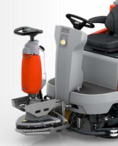
Doppelte Reinigungskraft: Mit einer speziellen Halterung lässt sich der Scrubmaster B5 einfach zum nächsten Einsatzort mitnehmen.
