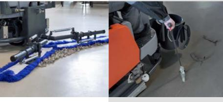
Mit dem Tool Leichtmüllsammler kann Grobschmutz von der Maschine aus per Greifzange aufgegriffen und im Müllbehälter gesammelt werden.
