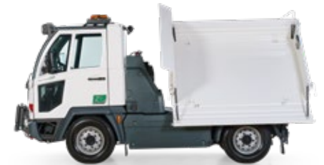
Flexibel: 3-Seiten-Kippaufbau, z.B. für den Transport von Schüttgütern oder im Baustelleneinsatz.
